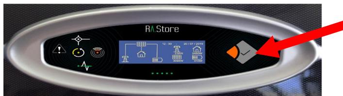
Figura 44 - Accesso al menù di settaggio: premere il tasto Enter
