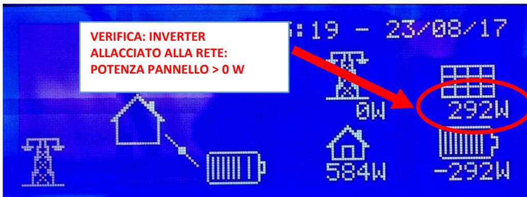
Figura 30 - La procedura di Checking è terminata; potenza pannello > 0 W
