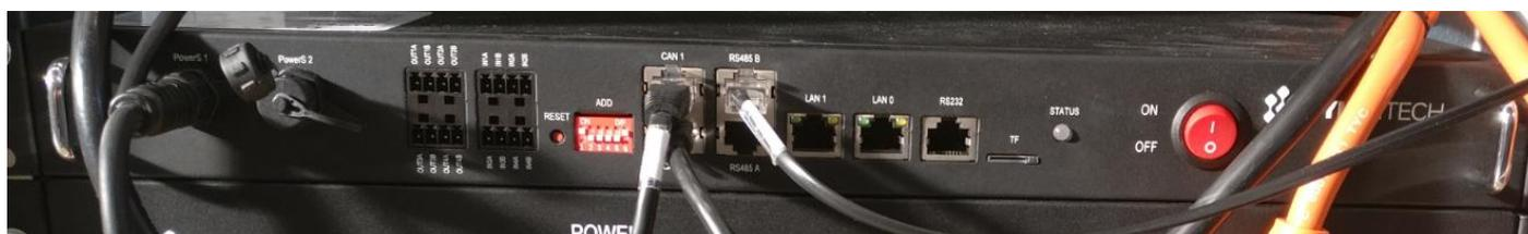
Figura 116 – Settaggio del selettore a DIP-SWITCH denominato "ADD" presente sull'unità supplementare di gestione delle batterie denominata "MBMS1000" installata sul telaio del RA STORE 3
