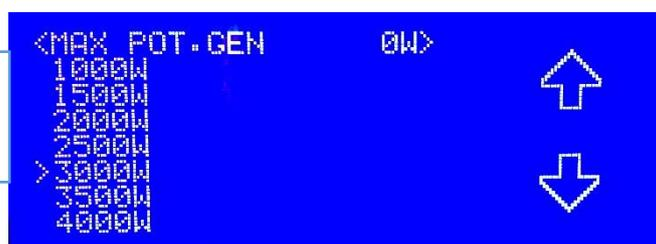
Figura 68 - Gen Diesel: settaggio del parametro "Max Pot.Gen"
