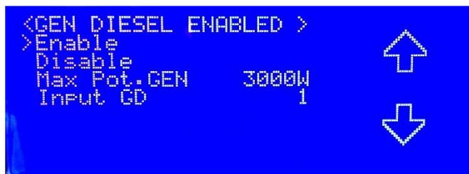
Figura 71 - Gen Diesel: schermata finale dopo aver settato tutti i parametri relativi al funzionamento
