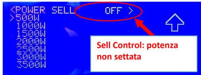
Figura 63 - Sell Control: Schermata di settaggio "Power Sell", il valore di potenza ceduta in rete oltre il quale commuta il relè RL2 (OUT2) presente sulla scheda di controllo macchina
