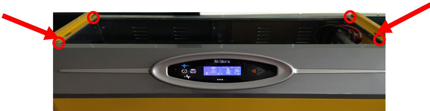
Figura 4 - Rimozione pannelli laterali
