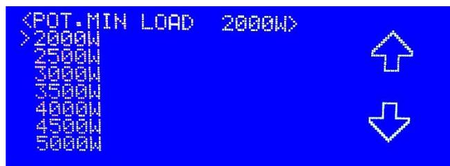
Figura 74 - Peak Shaving: settaggio parametro Pot. Min Load
