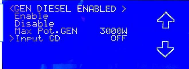
Figura 69 - Gen Diesel: settaggio del parametro "Input GD"
