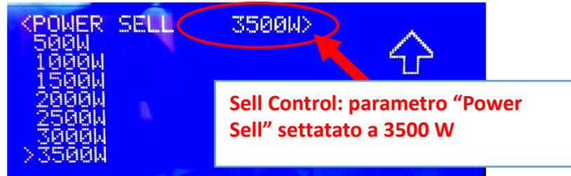
Figura 64 - Sell Control: Schermata di settaggio "Power Sell", valore di potenza ceduta in rete oltre il quale commuta il relè RL2 (OUT2) presente sulla scheda di controllo macchina; esempio di settaggio a 3500 W
