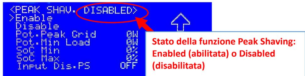
Figura 72 - Peak Shaving: schermata iniziale senza parametrizzazione
