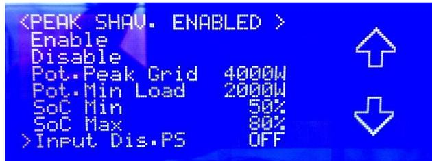
Figura 77 - Peak Shaving: esempio di settaggio parametri di lavoro;
