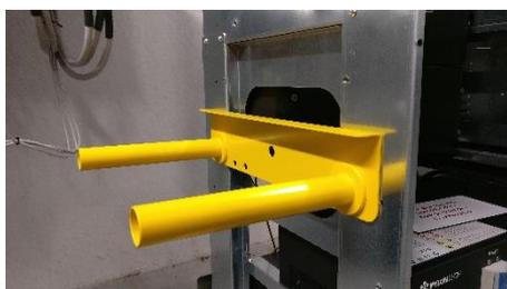
Figura 9 - Applicazione maniglie alla struttura sul fianco sinistro; replicare il montaggio sul fianco destro
