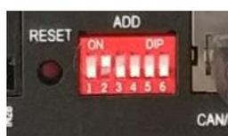
Figura 112 – Configurazione del commutatore a DIP-SWITCH del modulo BMS2B
