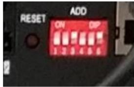
Figura 114 - Configurazione del commutatore a DIP-SWITCH del modulo BMS3B
