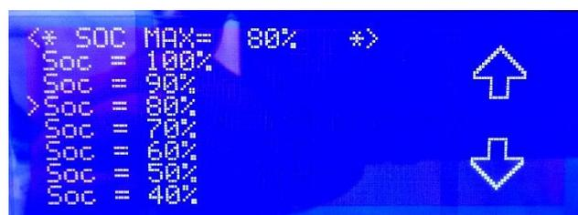
Figura 76 - Peak Shaving: settaggio parametro SoC Max
