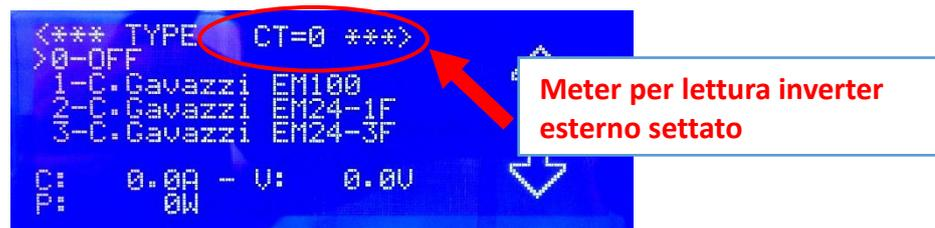
Figura 81 - External Inverter: scelta del Meter Carlo Gavazzi
