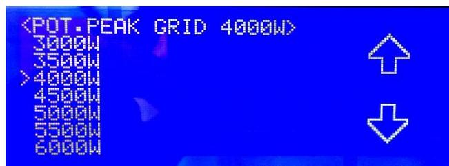
Figura 73 - Peak Shaving: settaggio parametro Pot. Peak Grid
