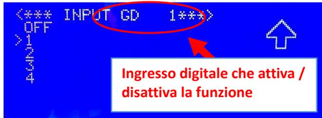
Figura 70 - Gen Diesel: scelta dell'ingresso digitale presente sulla scheda di controllo dell'accumulo che attiva / disattiva la funzione "GEN DIESEL"
